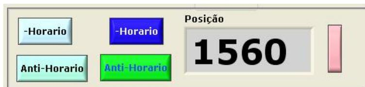
Figura 15-Acionamento manual do motor de passo, duas velocidades e leitura de posição.
