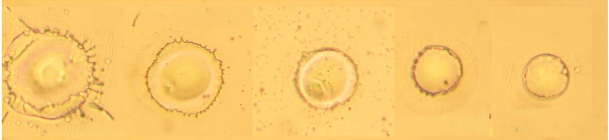
*Figura 27 Fotos dos danos no Si com energias de  $36\mu\text{J}$ ;  $25\mu\text{J}$ ;  $18\mu\text{J}$ ;  $12\mu\text{J}$  e  $8\mu\text{J}$ .*
